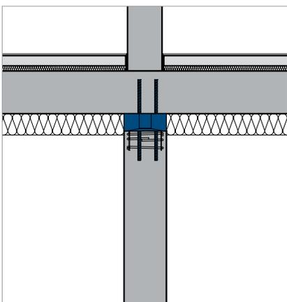
Anwendung am Stützenkopf für Unterdeckendämmung.
