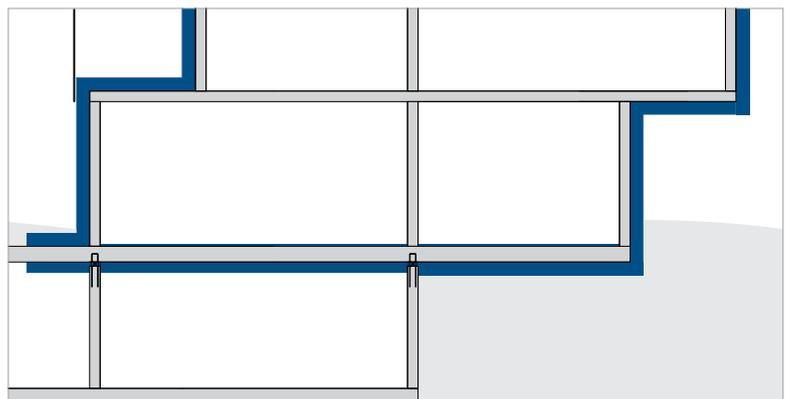
Stark reduzierter Materialaufwand durch thermische Trennung mit Schöck Sconnex® direkt im Bauteil
