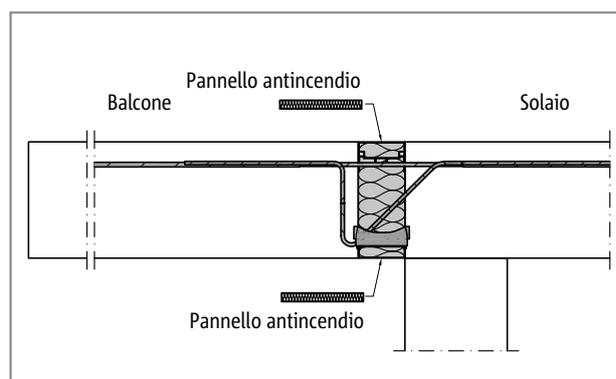
Fig. 203: Schöck Isokorb® tipo K: adeguamento postumo mediante pannelli antincendio
