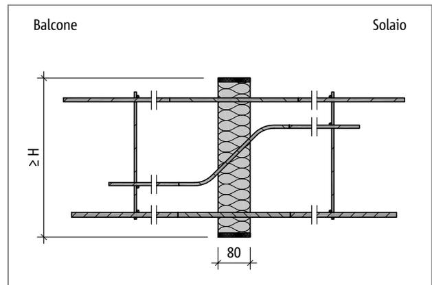
Fig. 177: Schöck Isokorb® tipo S R90, rivestito in stabilimento con pannelli antincendio
