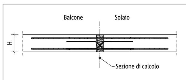
Fig. 144: Schöck Isokorb® tipo D, schema statico
