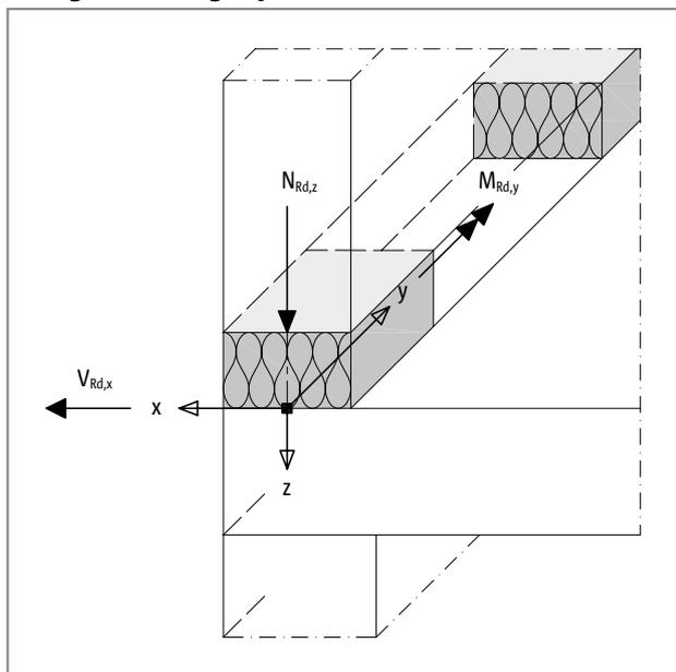
Fig. 184: Schöck Isokorb® tipo ABXT, regola dei segni per il calcolo di parapetti sovrapposti
