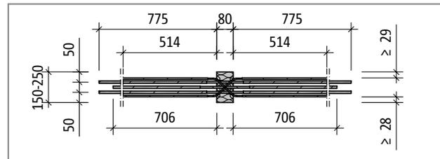
Fig. 165: Schöck Isokorb® tipo W20M, pianta del prodotto
