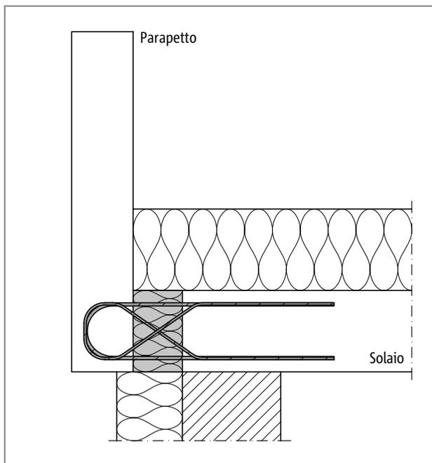
Fig. 183: Schöck Isokorb® tipo ABXT - disposizione orizzontale, parapetto anteposto
