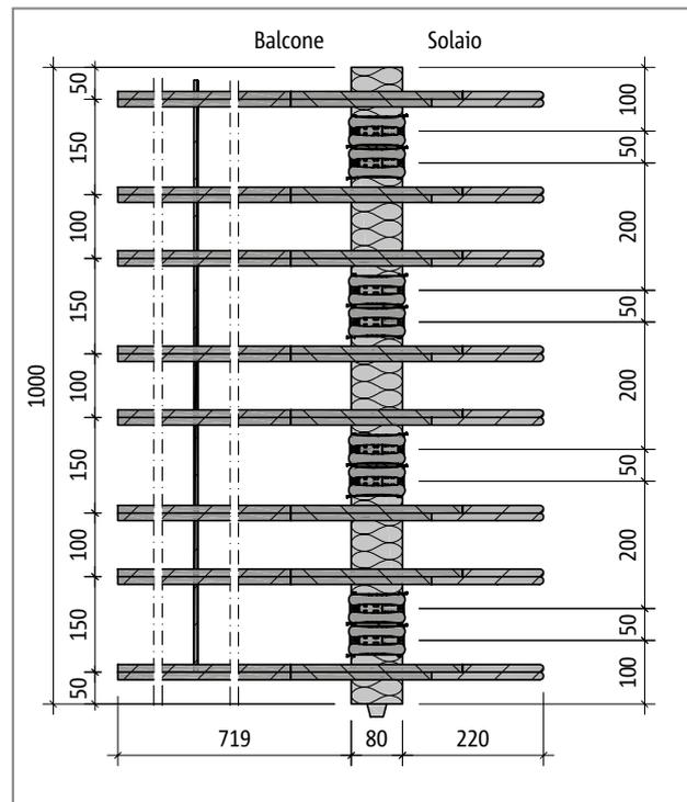
Fig. 129: Schöck Isokorb® tipo Q60M-VV, pianta del prodotto
