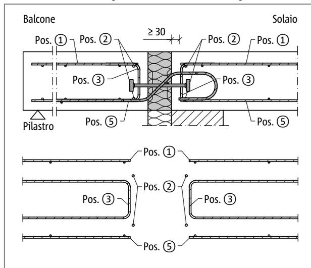
Fig. 136: Schöck Isokorb® tipo QP, armatura in opera
