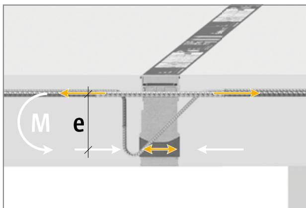
Fig. 15: Schöck Isokorb® tipo K, trasmissione del momento
