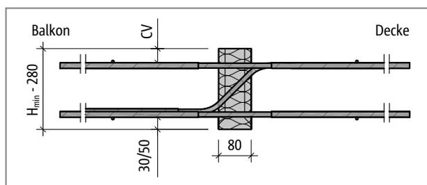
Fig. 73: Schöck Isokorb® tipo KP150L: Sezione dell'elemento
