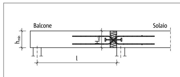
Fig. 118: Schöck Isokorb® tipo QP80L-VV: schema statico
