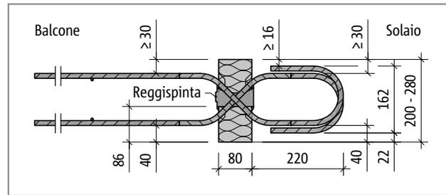
Fig. 127: Schöck Isokorb® tipo Q40M-VV – Q60M-VV, QP40M-VV e QP60M-VV: sezione dell'elemento
