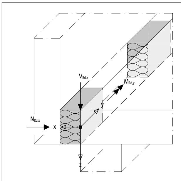
Fig. 185: Schöck Isokorb® tipo ABXT, regola dei segni per il calcolo dei parapetti anteposti
