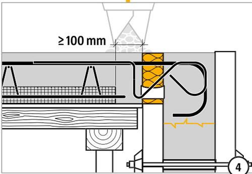
④ Nei giunti di compressione è necessaria una zona di getto in opera  $\geq 100$  mm!
