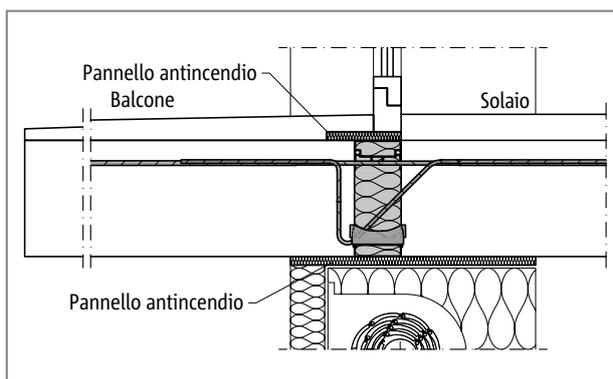
Fig. 199: Schöck Isokorb® tipo K: configurazione REI30 in corrispondenza dei cassonetti per avvolgibili e delle finestre con strato isolante minerale
