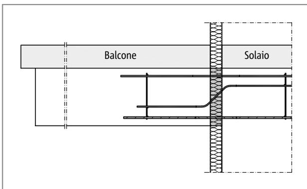
Fig. 174: Schöck Isokorb® tipo S, balcone con travi a sbalzo (balcone prefabbricato)
