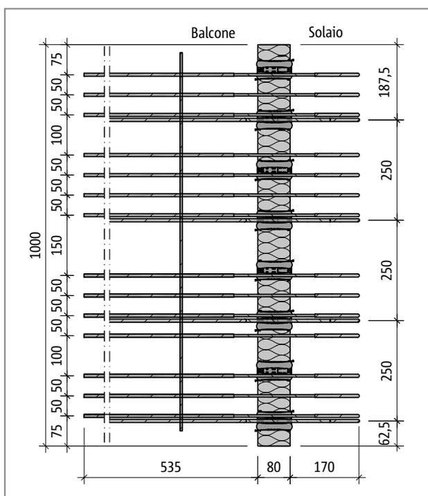
Fig. 95: Schöck Isokorb® tipo K50S-UZ: pianta del prodotto
