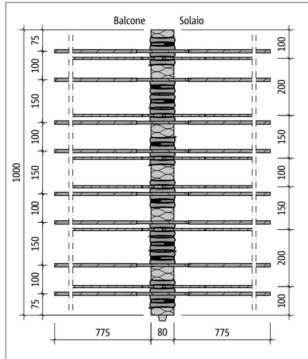
Fig. 71: Schöck Isokorb® tipo K70M, pianta del prodotto
