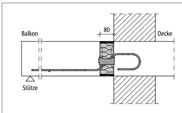
Fig. 197: Schöck Isokorb® tipo Q per REI120: pannello antincendio superiore ed inferiore
