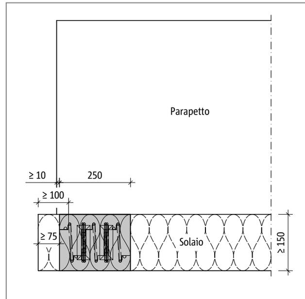
Fig. 190: Schöck Isokorb® tipo ABXT - disposizione orizzontale, distanze tra i bordi
