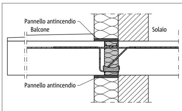
Fig. 198: Schöck Isokorb® tipo K: configurazione REI30 nel sistema di isolamento a cappotto con strato isolante minerale
