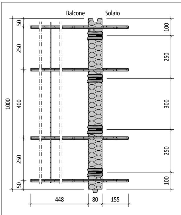
Fig. 128: Schöck Isokorb® tipo Q10S-VV, pianta del prodotto
