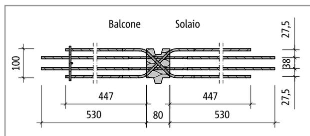
Fig. 159: Schöck Isokorb® tipo EQS, pianta del prodotto
