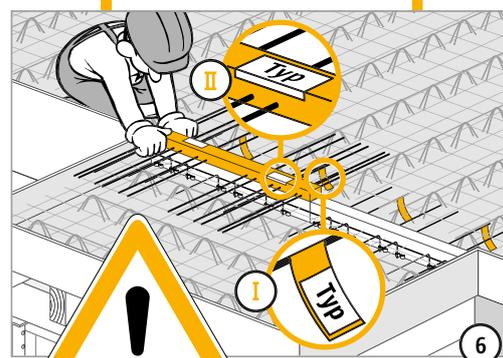
Installare obbligatoriamente la parte superiore II con barre tese!
