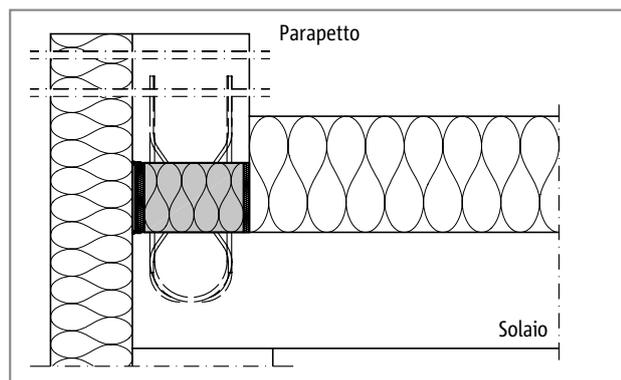
Fig. 196: Schöck Isokorb® tipo ZXT per EI120 con ABXT: pannello antincendio superiore ed inferiore
