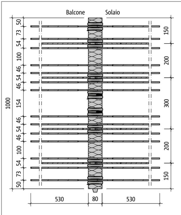
Fig. 70: Schöck Isokorb® tipo K50S, pianta del prodotto
