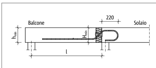
Fig. 112: Schöck Isokorb® tipo Q40M - Q60M: schema statico
