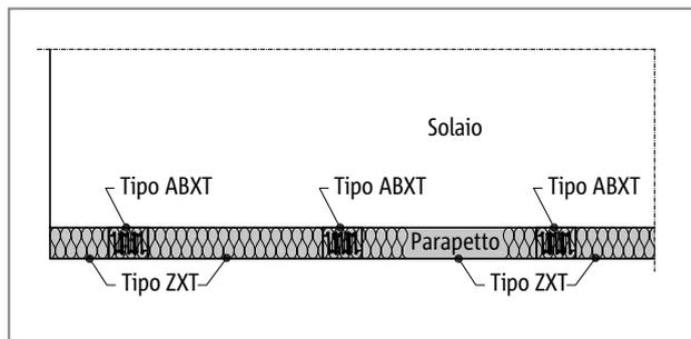
Fig. 178: Schöck Isokorb® tipo ABXT - disposizione verticale, pianta del parapetto sovrapposto
