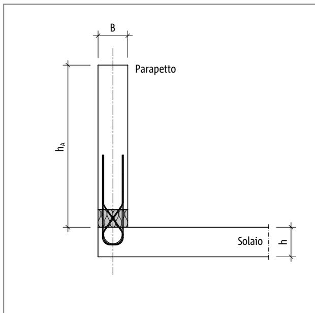
Fig. 186: Schöck Isokorb® tipo ABXT, schema statico con altezza del parapetto  $h_A$
