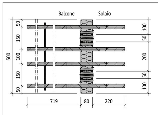
Fig. 131: Schöck Isokorb® tipo QP60M-VV, pianta del prodotto
