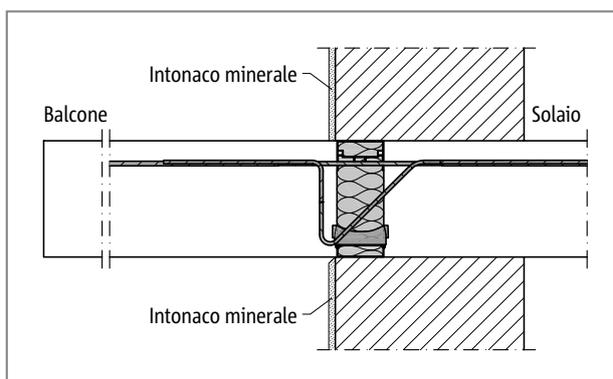
Fig. 201: Schöck Isokorb® tipo K: configurazione REI30 in corrispondenza della parete su esempio del tipo K
