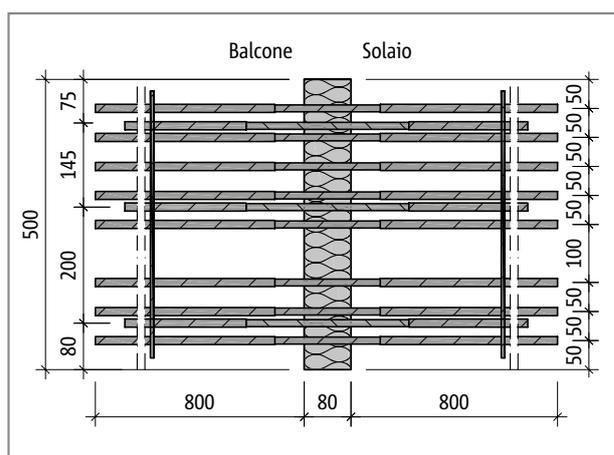
Fig. 75: Schöck Isokorb® tipo KP150L-V14: pianta del prodotto
