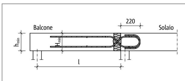
Fig. 114: Schöck Isokorb® tipo Q40M-VV - Q60M-VV: schema statico
