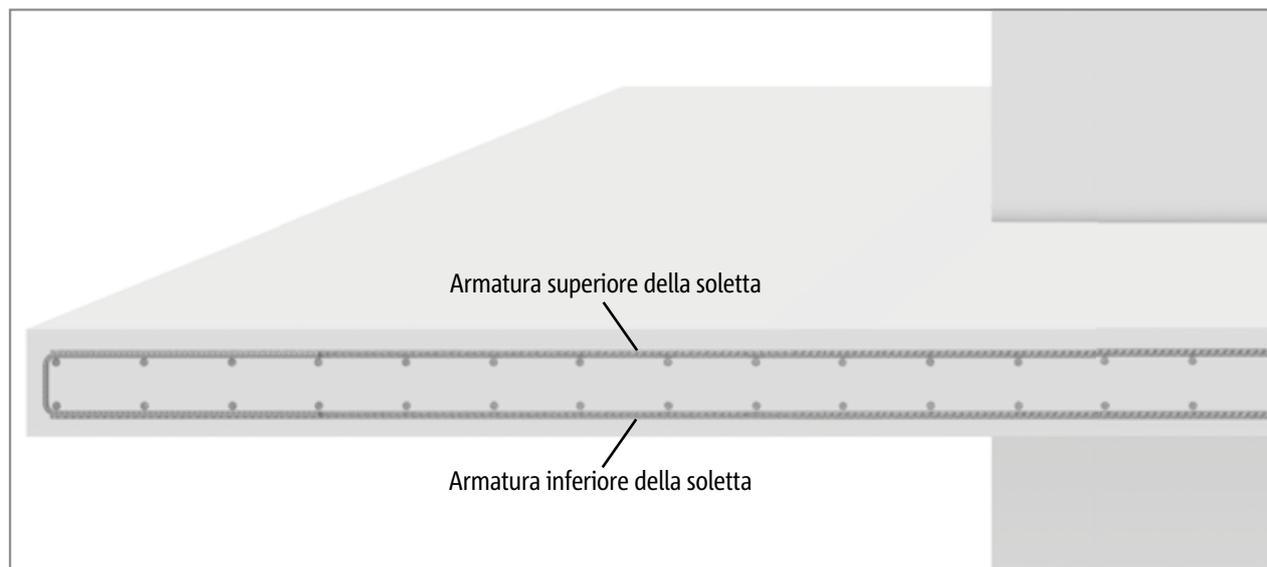
Fig. 10: armatura di una soletta di balcone
