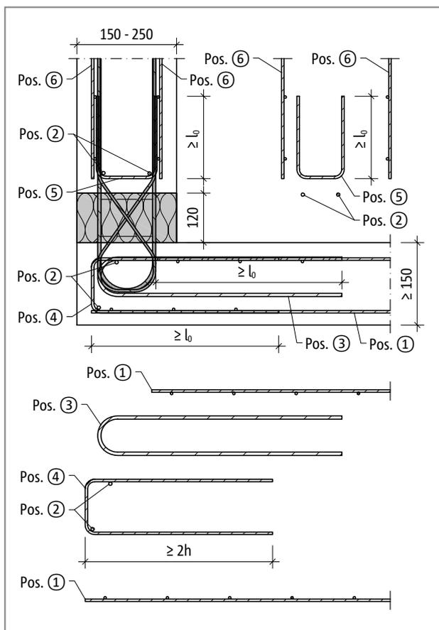
Fig. 194: Schöck Isokorb® tipo ABXT - disposizione verticale, armatura in opera
