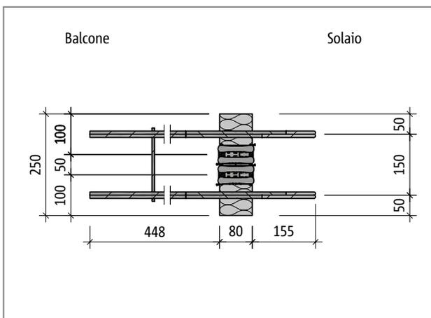
Fig. 130: Schöck Isokorb® tipo QP10S-VV, pianta del prodotto
