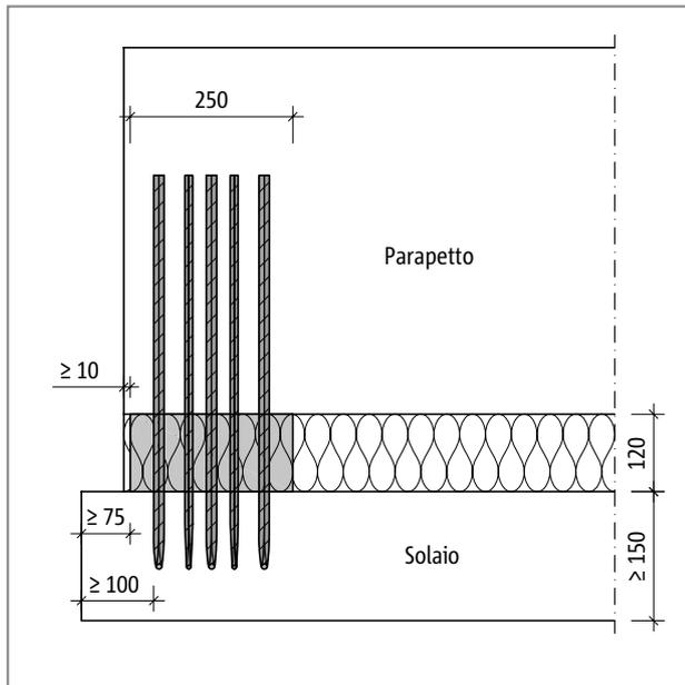
Fig. 189: Schöck Isokorb® tipo ABXT - disposizione verticale, distanze tra i bordi
