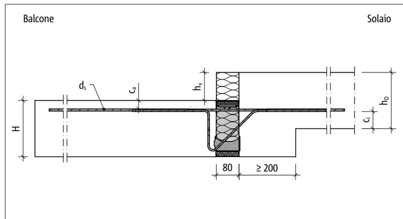
Fig. 82: Schöck Isokorb® tipo K, abbassamento di quota
