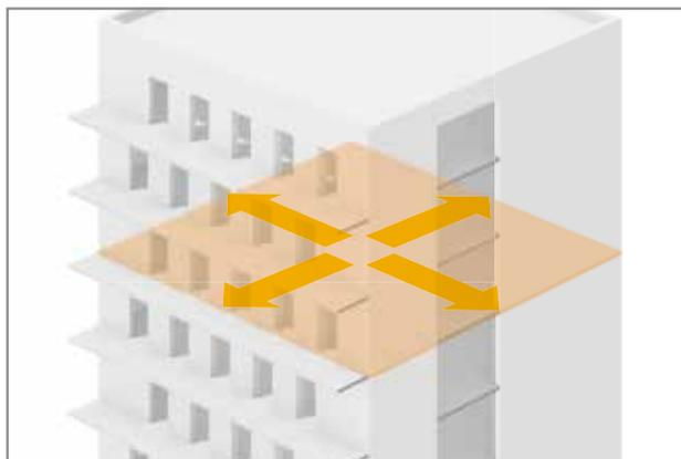
Fig. 21: direzioni della vibrazione di un edificio in caso di sisma
