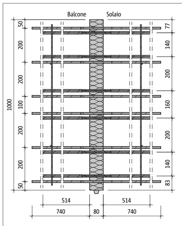
Fig. 147: Schöck Isokorb® tipo D20M, pianta del prodotto
