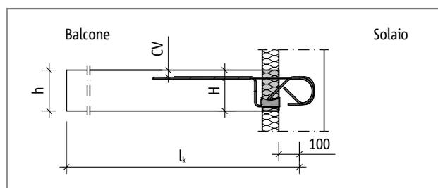
Fig. 91: Schöck Isokorb® tipo K10S-UZ – K60S-UZ: schema statico
