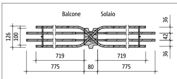
Fig. 160: Schöck Isokorb® tipo EQM, pianta del prodotto
