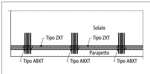
Fig. 179: Schöck Isokorb® tipo ABXT - disposizione verticale, pianta del parapetto anteposto
