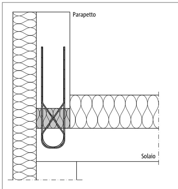
Fig. 182: Schöck Isokorb® tipo ABXT - disposizione verticale, parapetto sovrapposto
