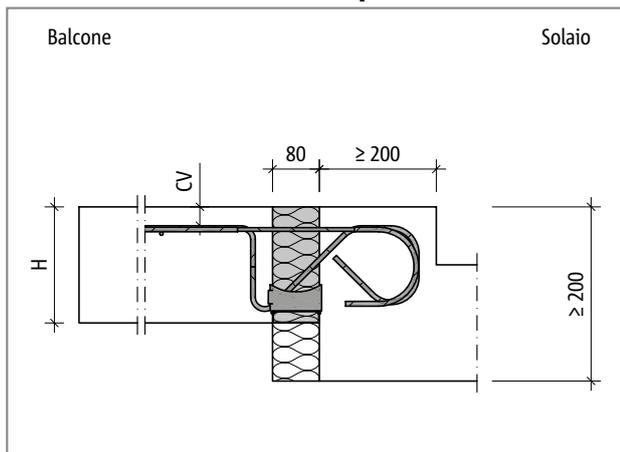
Fig. 85: Schöck Isokorb® tipo K10S-UZ – K60S-UZ: balcone con innalzamento e isolamento esterno
