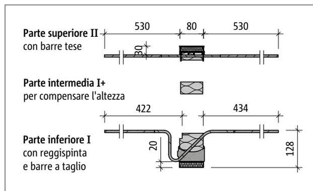
Fig. 79: Schöck Isokorb® tipo KF10S - KF60S
