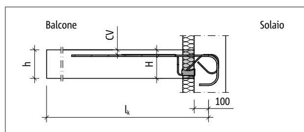
Fig. 92: Schöck Isokorb® tipo K70M-UZ – K110M-UZ: schema statico
