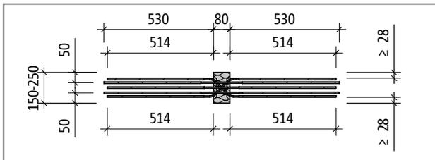
Fig. 164: Schöck Isokorb® tipo W10S, pianta del prodotto
