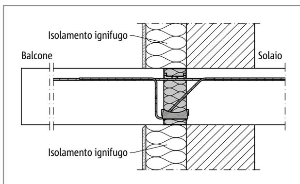
Fig. 200: Schöck Isokorb® tipo K: inserito in materiali ignifughi, REI30
