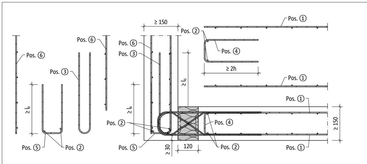
Fig. 193: Schöck Isokorb® tipo ABXT - disposizione orizzontale, armatura in opera
