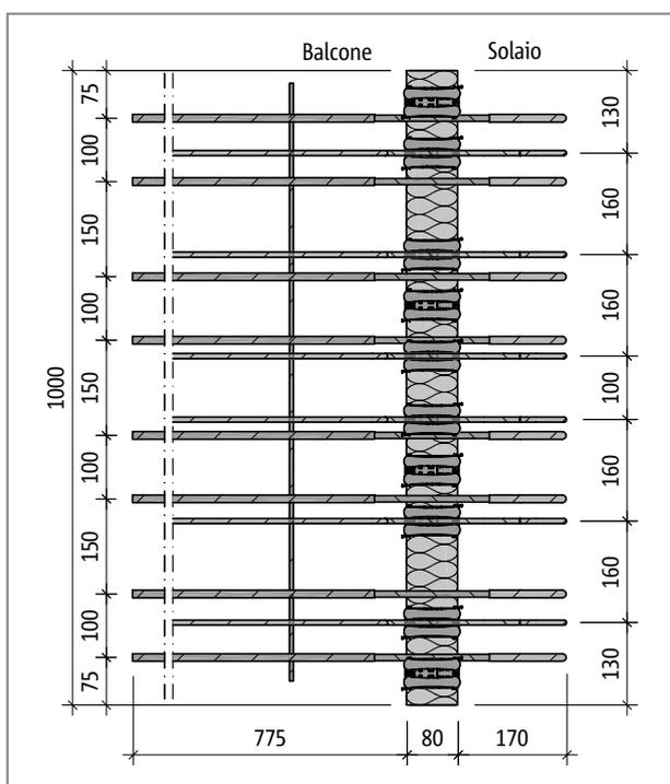
Fig. 96: Schöck Isokorb® tipo K70M-UZ: pianta del prodotto
