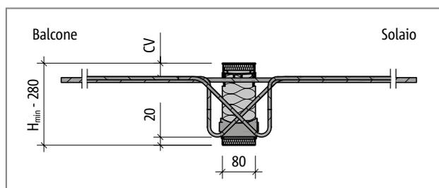
Fig. 72: Schöck Isokorb® tipo K70M-VV – K110M-VV: Sezione dell'elemento
