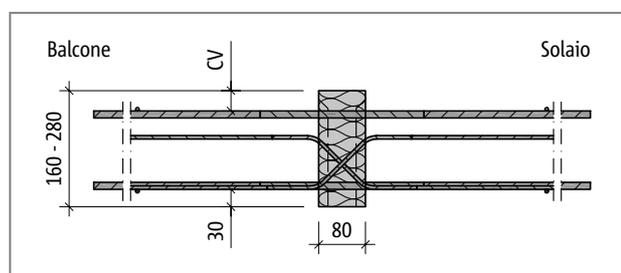
Fig. 145: Schöck Isokorb® tipo D, sezione del prodotto
