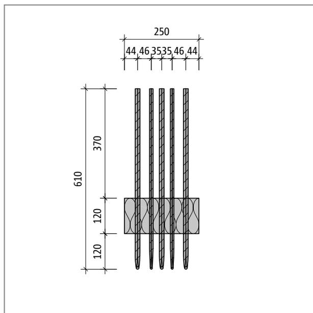
Fig. 192: Schöck Isokorb® tipo ABXT, sezione longitudinale del prodotto
