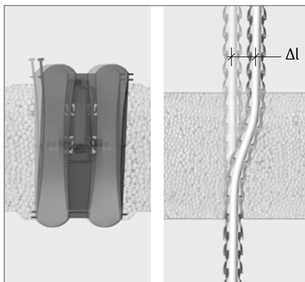
Fig. 38: Schöck Isokorb®: spostamento della barra di trazione e del reggispinta HTE-Compact® in presenza di sollecitazione termica
