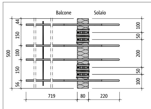
Fig. 125: Schöck Isokorb® tipo QP60M: pianta del prodotto
