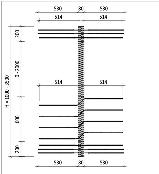
Fig. 166: Schöck Isokorb® tipo W10S, sezione del prodotto
