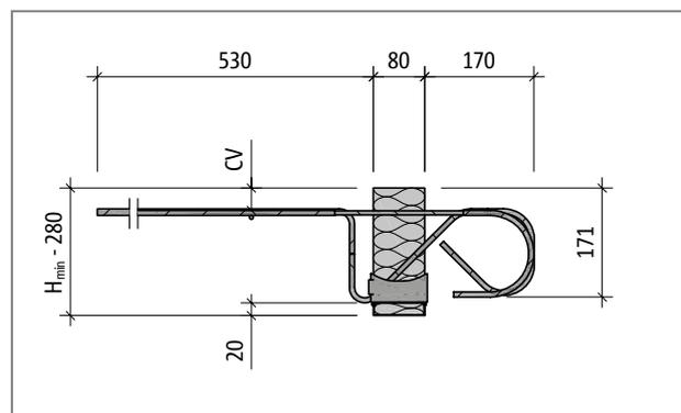
Fig. 89: Schöck Isokorb® tipo K10S-UZ – K60S-UZ: Sezione dell'elemento
