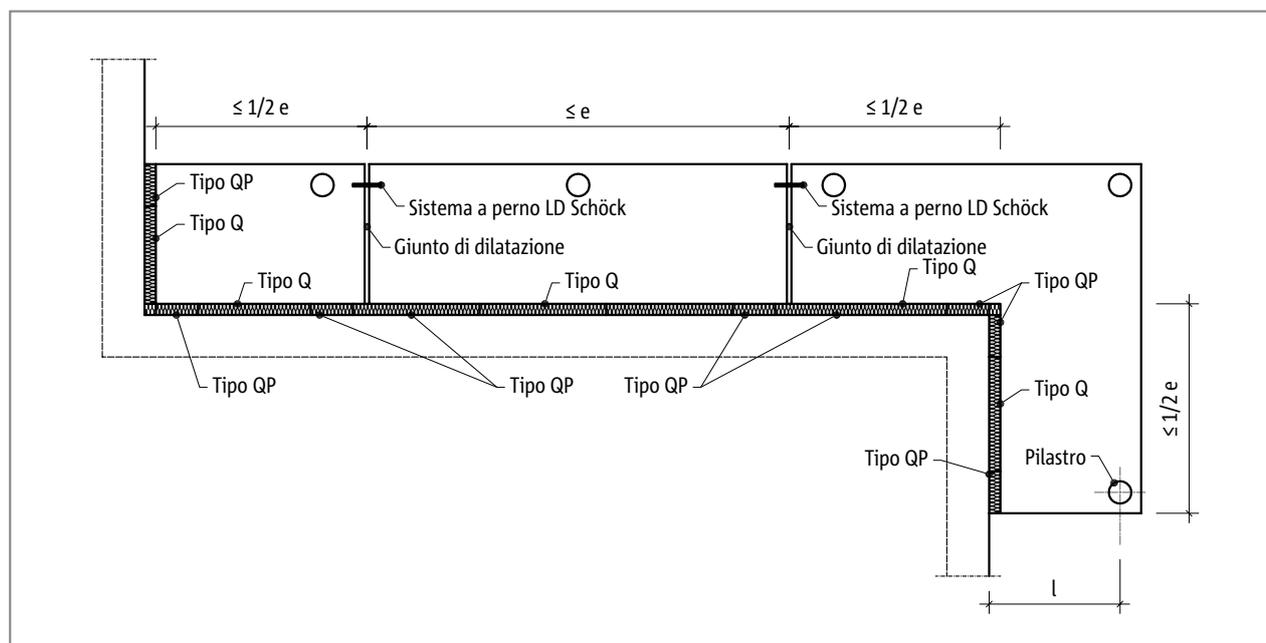
Fig. 119: Schöck Isokorb® tipo Q, QP: giunti di dilatazione con perno a taglio scorrevole longitudinalmente, p. es. sistema a perno Schöck
