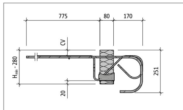
Fig. 90: Schöck Isokorb® tipo K70M-UZ – K110M-UZ: Sezione dell'elemento
