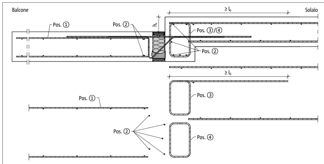
Fig. 101: Schöck Isokorb® tipo K, armatura in opera per piccoli salti di quota
