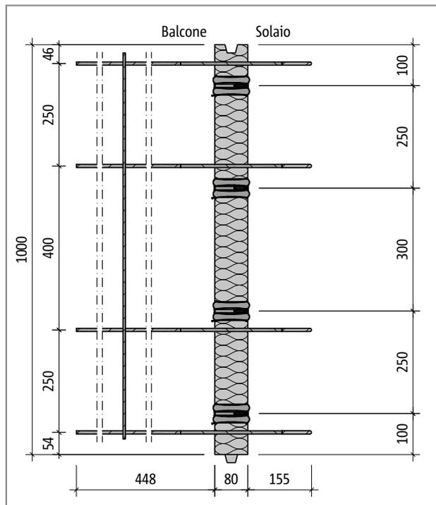
Fig. 122: Schöck Isokorb® tipo Q10S, pianta del prodotto
