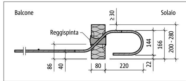
Fig. 121: Schöck Isokorb® tipologie Q40M – Q60M, QP40M e QP60M: sezione dell'elemento
