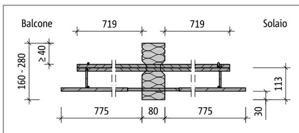
Fig. 158: Schöck Isokorb® tipo EQM, sezione dell'elemento
