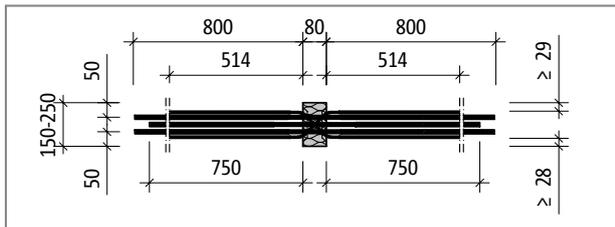
Fig. 168: Schöck Isokorb® tipo W30L: pianta del prodotto
