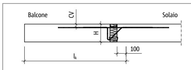
Fig. 66: Schöck Isokorb® tipo K: schema statico
