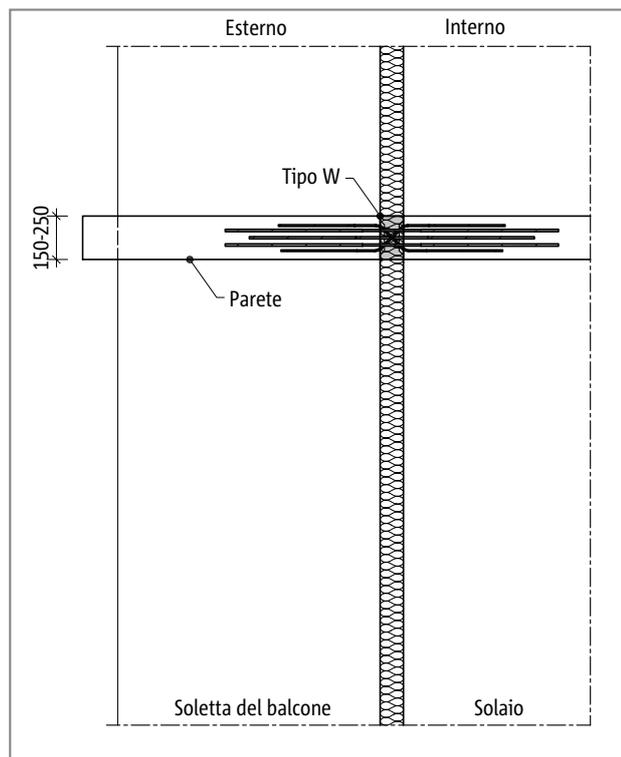
Fig. 161: Schöck Isokorb® tipo W, pianta del prodotto
