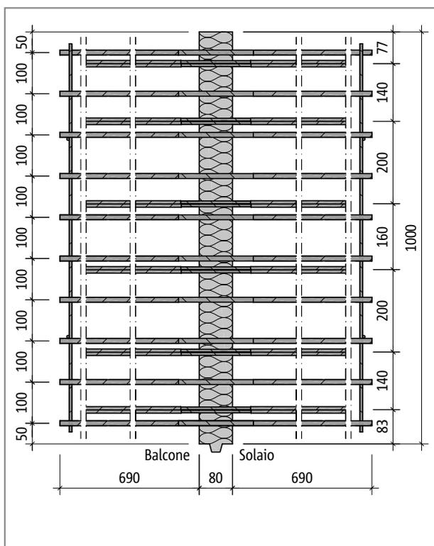
Fig. 148: Schöck Isokorb® tipo D40M, pianta del prodotto
