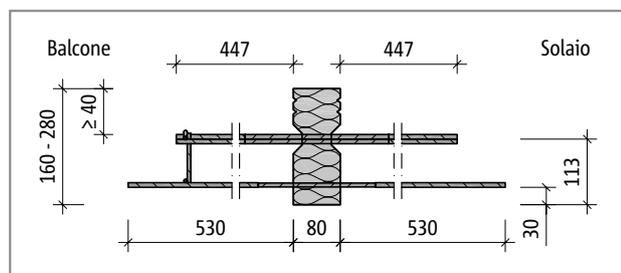
Fig. 157: Schöck Isokorb® tipo EQS, sezione del prodotto
