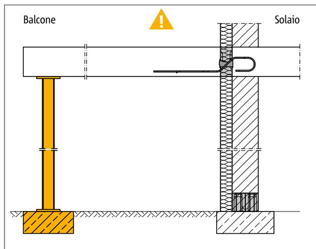
Fig. 138: Schöck Isokorb® tipo QP, è necessario un sostegno continuo
