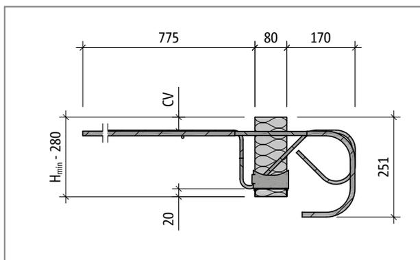
Fig. 94: Schöck Isokorb® tipo K70M-UZ – K110M-UZ: Sezione dell'elemento
