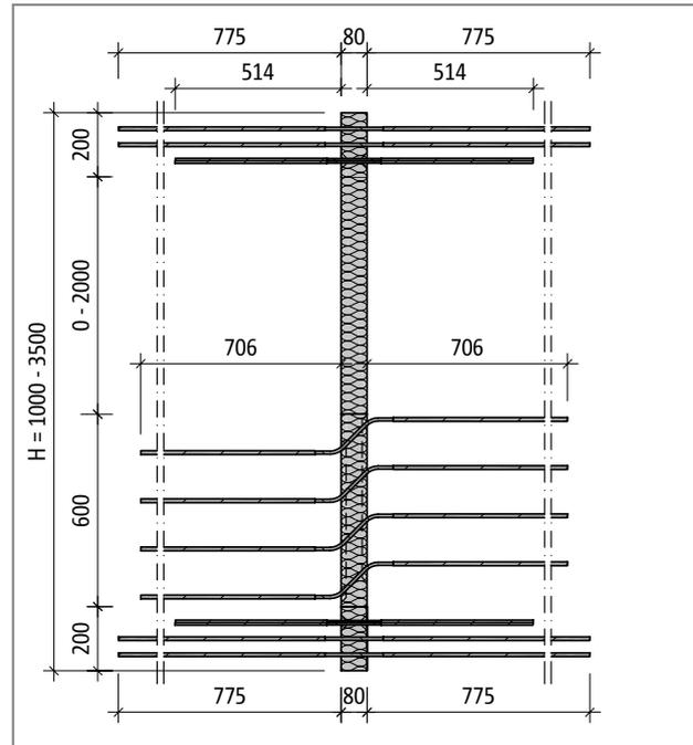
Fig. 167: Schöck Isokorb® tipo W20M, sezione del prodotto
