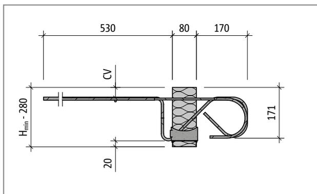
Fig. 93: Schöck Isokorb® tipo K10S-UZ – K60S-UZ: Sezione dell'elemento
