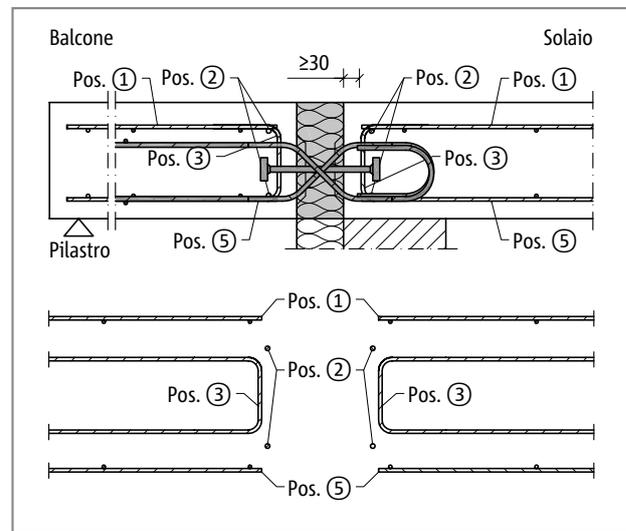
Fig. 137: Schöck Isokorb® tipo QP-VV, armatura in opera
