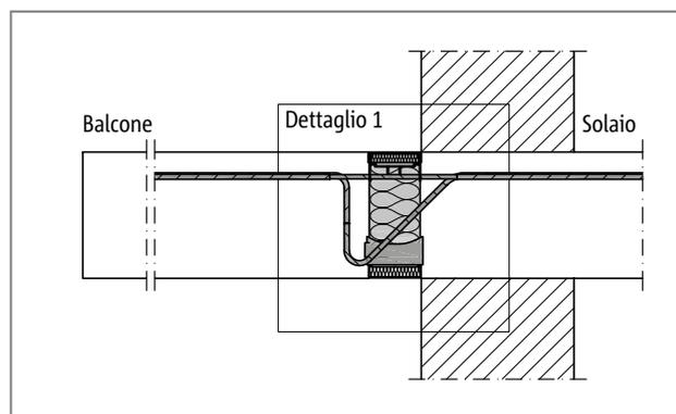
Fig. 195: Schöck Isokorb® tipo K per REI120: pannello antincendio superiore ed inferiore; nastri di protezione antincendio laterali
