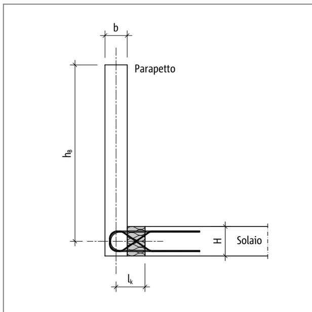
Fig. 187: Schöck Isokorb® tipo ABXT, schema statico con altezza del parapetto  $h_B$
