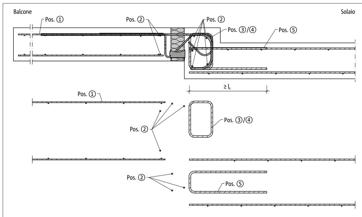
Fig. 102: Schöck Isokorb® tipo K-UZ: Armatura in opera
