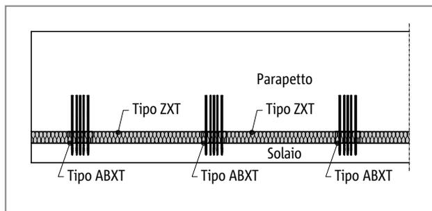
Fig. 180: Schöck Isokorb® tipo ABXT - disposizione verticale, parapetto sovrapposto
