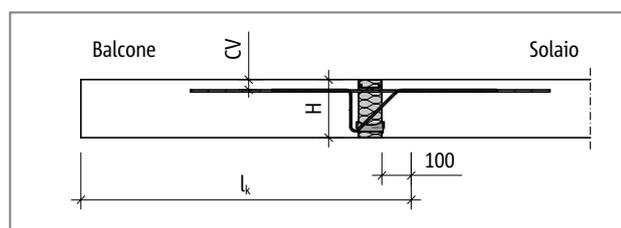
Fig. 65: Schöck Isokorb® tipo K: schema statico
