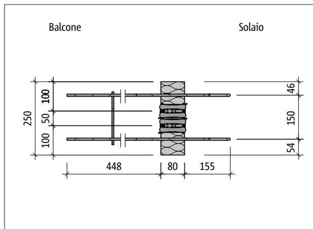
Fig. 124: Schöck Isokorb® tipo QP10S: pianta del prodotto
