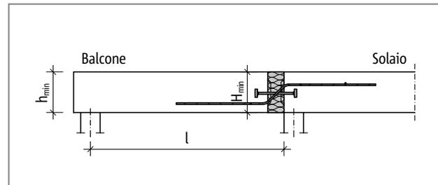
Fig. 116: Schöck Isokorb® tipo QP80L: schema statico
