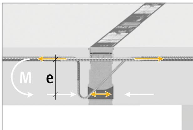
Fig. 44: Schöck Isokorb® tipo K, trasmissione del momento
