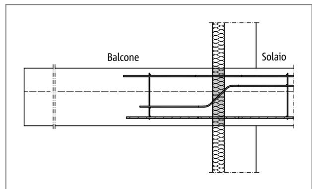
Fig. 175: Schöck Isokorb® tipo S, balcone con travi a sbalzo
