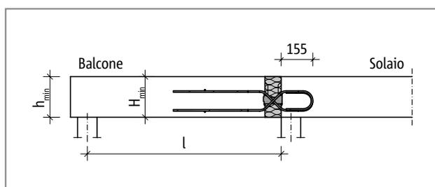
Fig. 113: Schöck Isokorb® tipo Q10S-VV - Q30S-VV: schema statico
