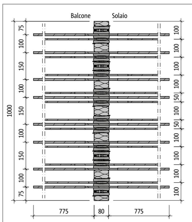
Fig. 74: Schöck Isokorb® tipo K70M-VV: pianta del prodotto
