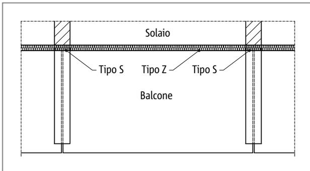
Fig. 172: Schöck Isokorb® tipo S, balcone con travi a sbalzo (balcone prefabbricato)
