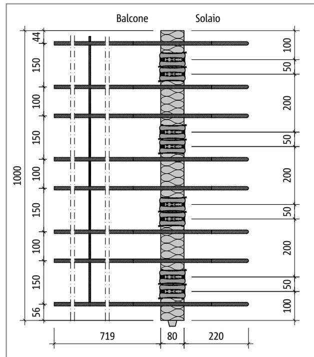
Fig. 123: Schöck Isokorb® tipo Q60M: pianta del prodotto
