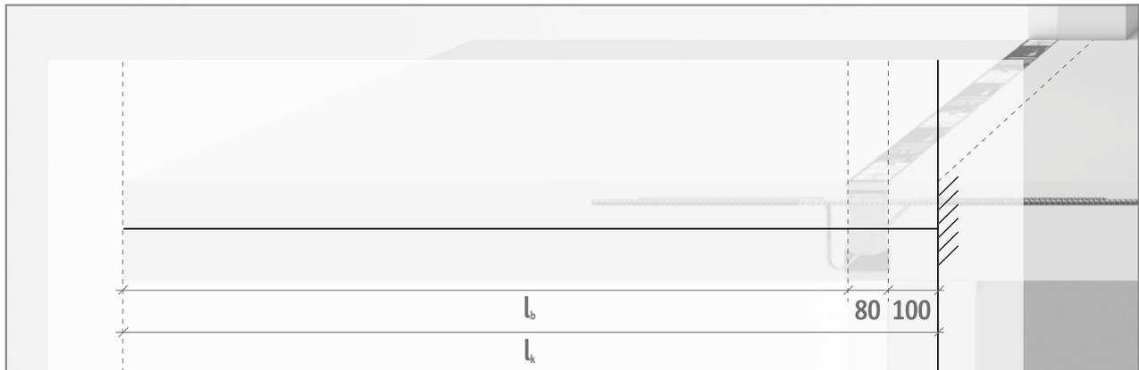
Fig. 41: Schöck Isokorb® tipo K, schema statico
