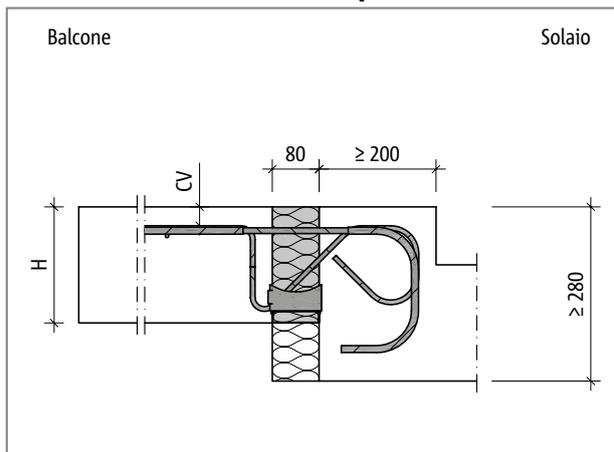
Fig. 86: Schöck Isokorb® tipo K70M-UZ – K110M-UZ: balcone con innalzamento e isolamento esterno
