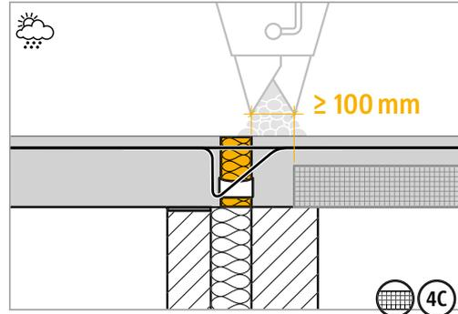
④A-④C Nei giunti di compressione è necessaria una zona di getto in opera  $\ge 100\text{ mm}$ !
