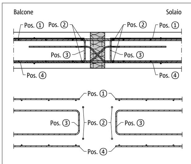
Fig. 151: Schöck Isokorb® tipo D, armatura in opera
