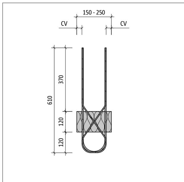
Fig. 191: Schöck Isokorb® tipo ABXT, sezione trasversale del prodotto
