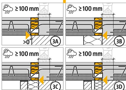
Nei giunti di compressione è necessaria una zona di getto in opera  $\geq 100$  mm!
