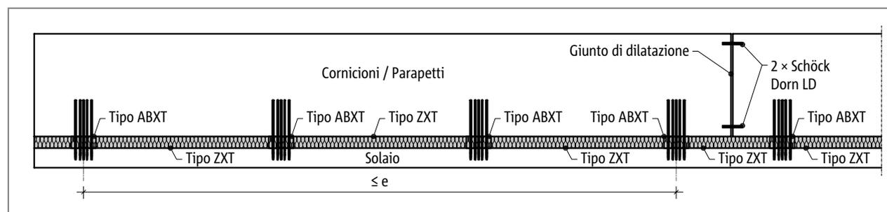
Fig. 188: Schöck Isokorb® tipo ABXT: disposizione dei giunti di dilatazione
