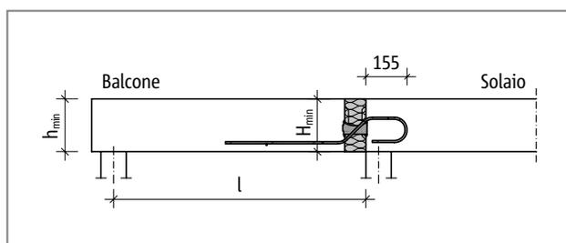
Fig. 111: Schöck Isokorb® tipo Q10S - Q30S: schema statico
