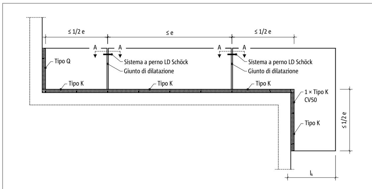
Fig. 67: Schöck Isokorb® tipo K, raffigurazione dei giunti di dilatazione con perno a taglio (per es. sistema a perno Schöck) scorrevole nella direzione orizzontale.
