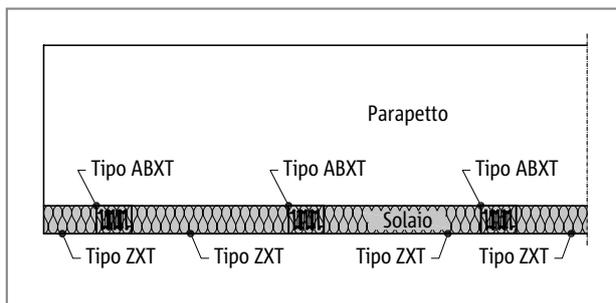
Fig. 181: Schöck Isokorb® tipo ABXT - disposizione orizzontale, parapetto anteposto
