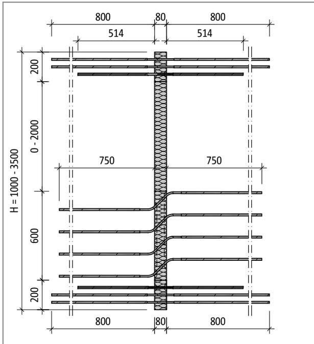
Fig. 169: Schöck Isokorb® tipo W30L: sezione dell'elemento
