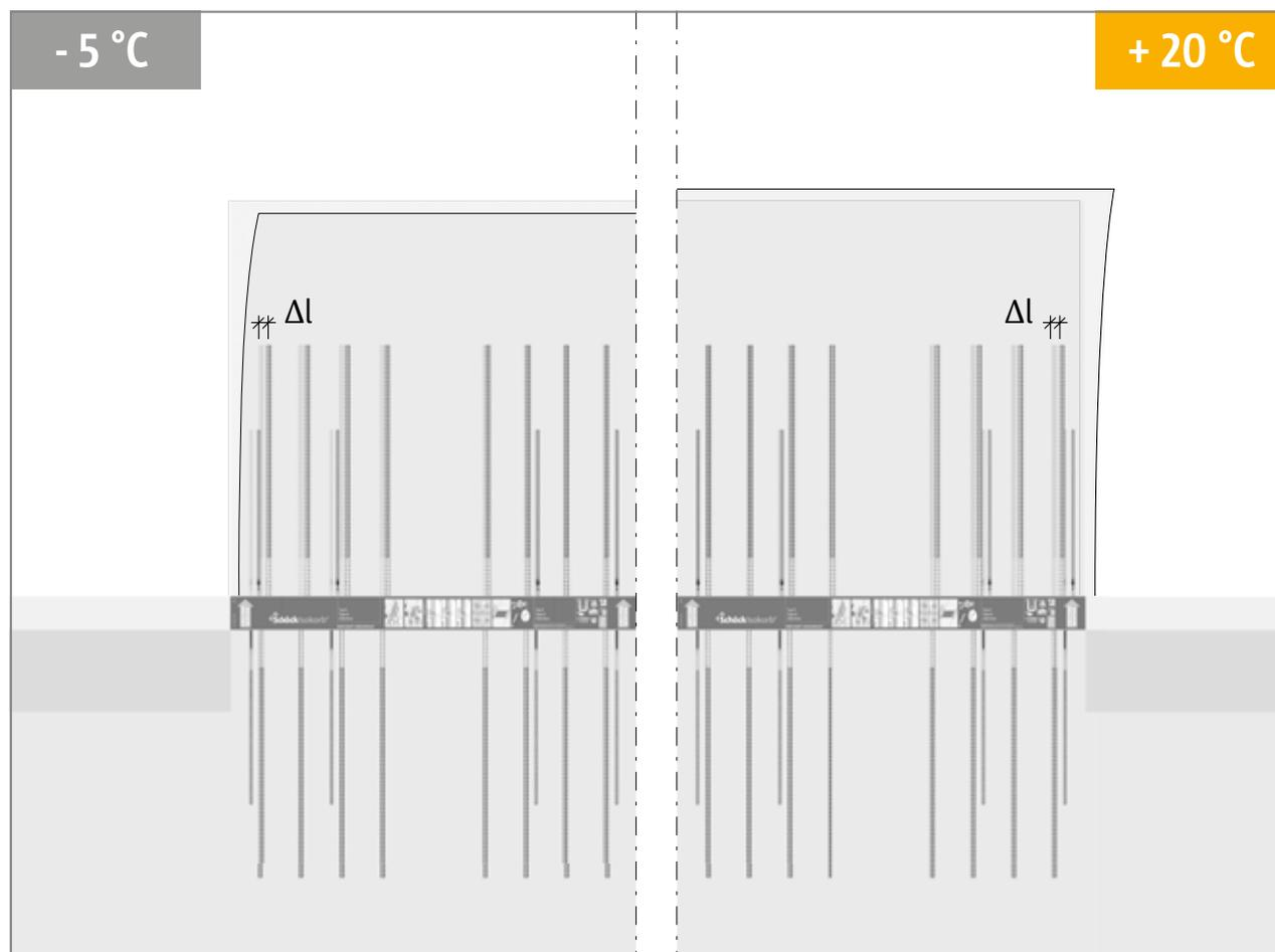
Fig. 37: Schöck Isokorb®, deformazione dovuta a carico termico
