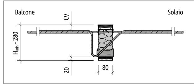
Fig. 69: Schöck Isokorb® tipo K70M - K110M, sezione del prodotto
