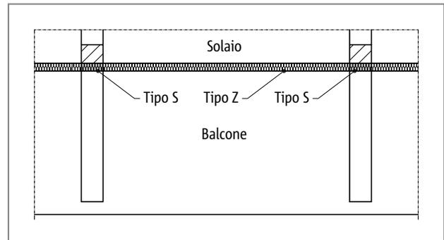
Fig. 173: Schöck Isokorb® tipo S, balcone con travi a sbalzo
