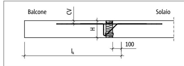
Fig. 78: Schöck Isokorb® tipo K: schema statico
