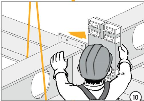
⑩ Amener la poutre métallique extérieure avec platine frontale sur le raccordement pour poutre préparé au préalable avec le module Schöck Isokorb® et les pièces d'isolation thermique. La poutre métallique extérieure doit être amenée de façon à ne pas entraîner de contraintes lors de l'emboîtement dans les boulons du Schöck Isokorb®.
