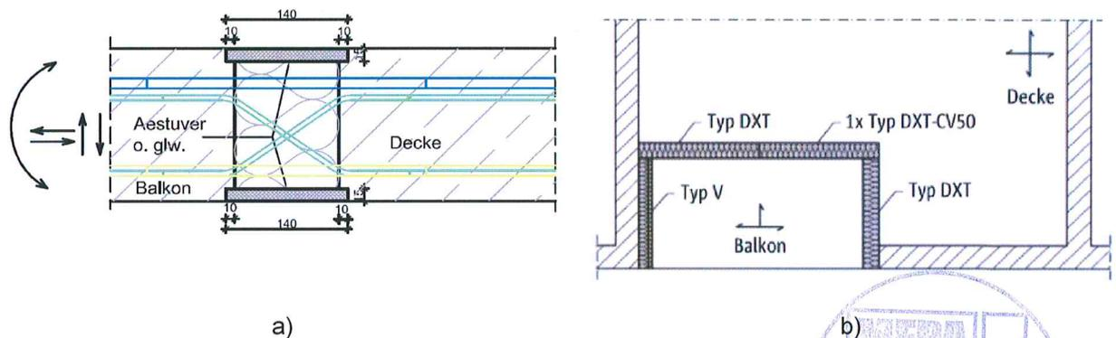
**Bild 5:** Schematische Darstellung einer Schöck Isokorb® Typ DXT
