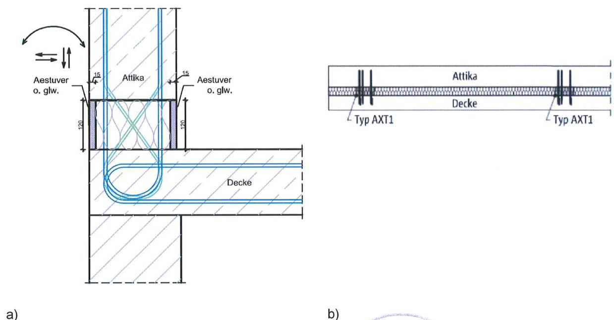
**Bild 11:** Schematische Darstellung einer Schöck Isokorb® Typ AXT
