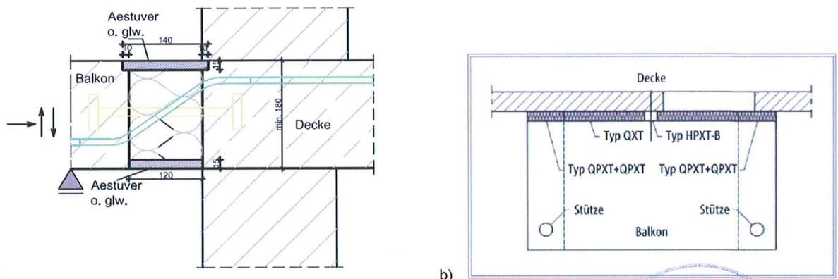
**Bild 7:** Schematische Darstellung einer Schöck Isokorb® Typ QPXT
