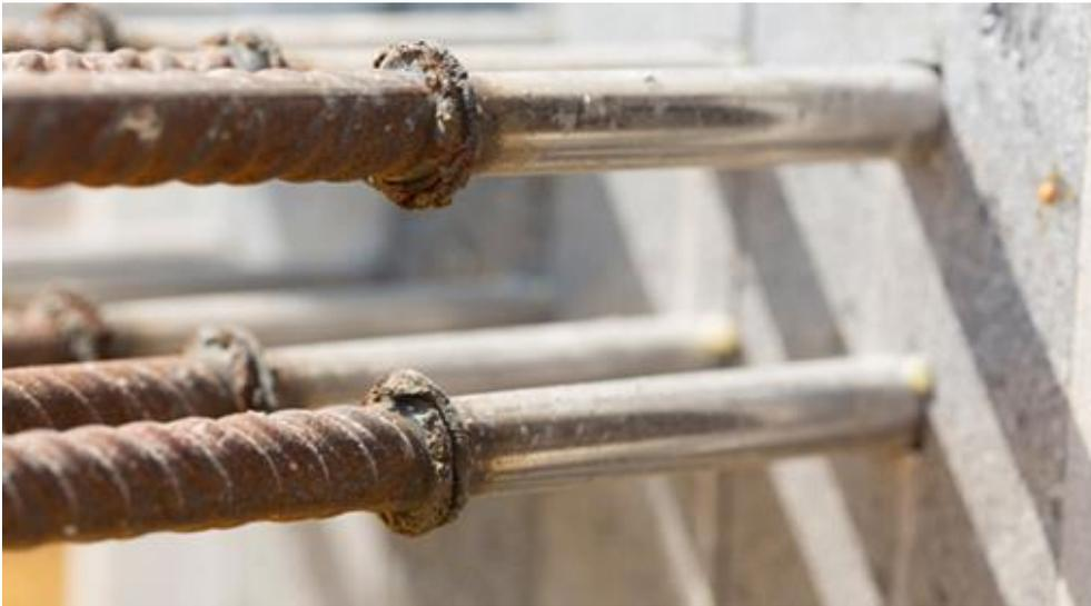
*Die Zug- und Querkraftstäbe des Isokorb bestehen aus Beton- und Edelstahl. Der Edelstahl ist mit seiner deutlich geringeren Wärmeleitfähigkeit besser für die Durchdringung des Dämmkörpers geeignet. Foto: Fotostudio Huger, Abdruck honorarfrei.*
