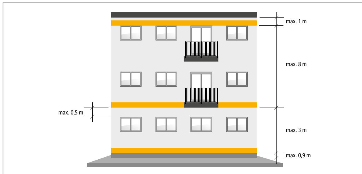
Abb. 6: Anordnung von Balkonen im Brandriegel
