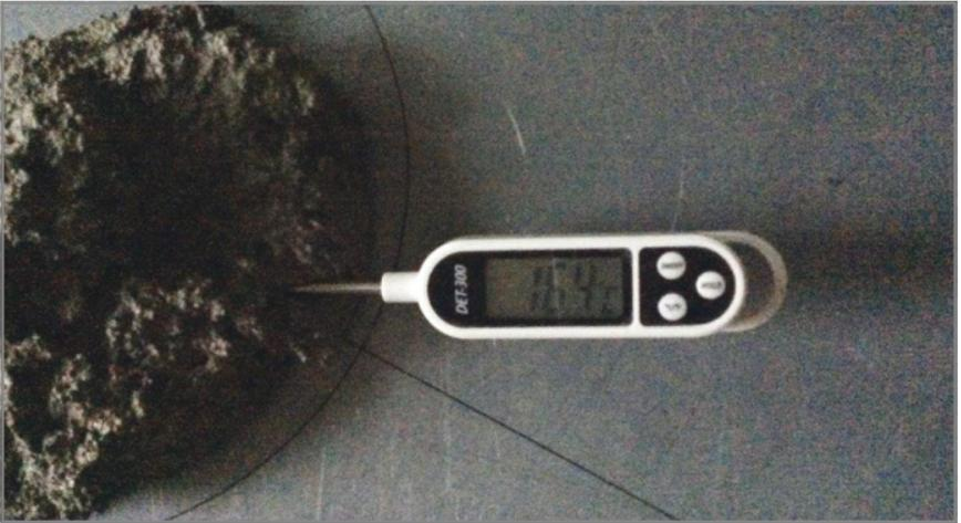
Fig. 55: mesure de la température, mélange prêt à l'emploi
