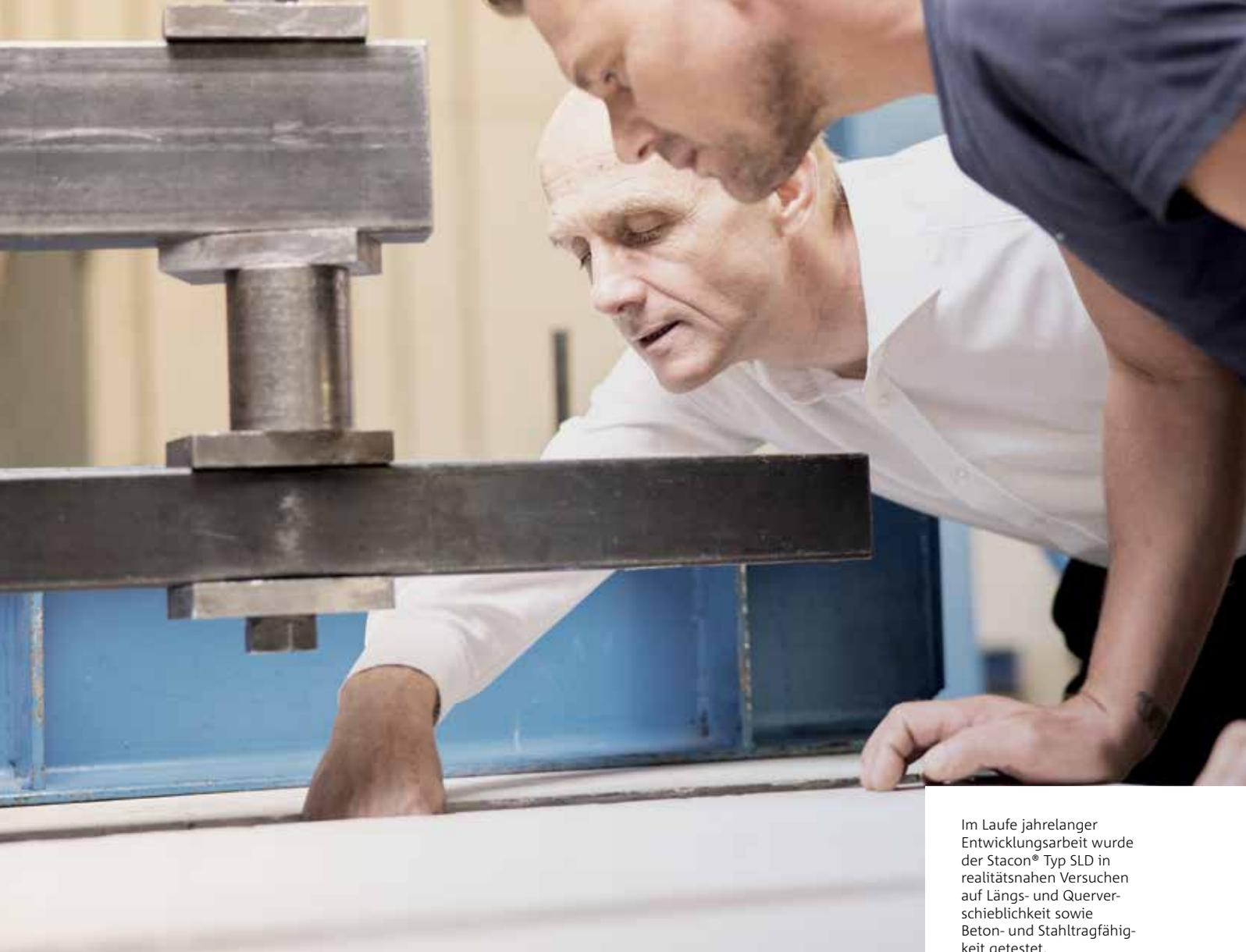
Im Laufe jahrelanger Entwicklungsarbeit wurde der Stacon® Typ SLD in realitätsnahen Versuchen auf Längs- und Querverschieblichkeit sowie Beton- und Stahltragfähigkeit getestet.
